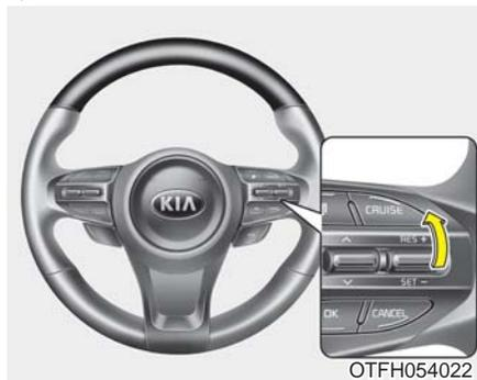
如果使用巡航(CRUISE)按钮以外的方式解除了巡航速度控制，巡航控制系统仍处于工作状态。推RES+开关时，会自动恢复到最近设定的巡航速度。
