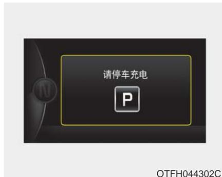
如果充电状态(SOC)非常低，LCD显示器上显示“请停车充电”信息。此时应尽快在安全地方停车，并将变速杆挂到P(驻车)档，并给混合动力蓄电池充电。
