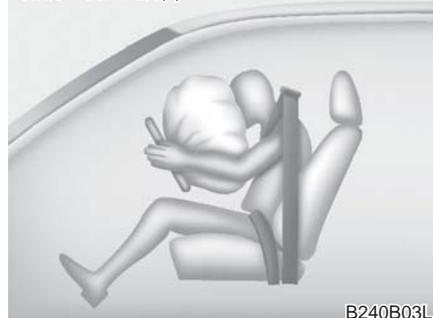
完全展开的空气囊结合正确佩戴的安全带能减缓驾驶员或乘员的前冲运动，降低头部和胸部的受伤机率。
