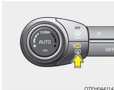
发动机运转期间除霜器加热后窗，从而除去后窗的霜、雾和薄冰。
