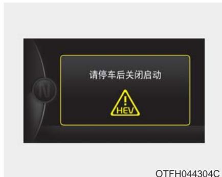
如果混合动力系统发生故障，在LCD显示器上会显示“请停车后关闭启动”警告信息，并准备就绪指示灯闪烁和警告音响起，直到排除故障为止。
