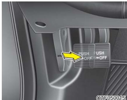
检查用20kg(44 lb, 196N)的力踩下驻车制动踏板时行程是否在规定范围内。应仅用驻车制动器就能把车辆固定在相当陡的斜坡上。
