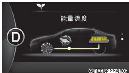
利用再生制动给混合动力蓄电池充电。(车轮→蓄电池)
