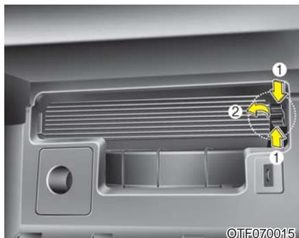
3. 在按下盖右侧的锁片状态，拆卸空调空气滤清器盖。
