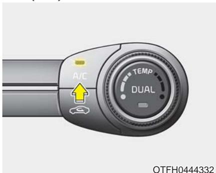
按下A/C按钮可运转制冷系统(指示灯亮)。再按一下A/C按钮可关闭制冷系统。
