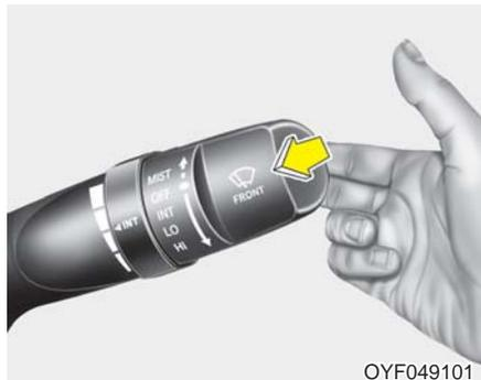
在OFF位置，朝您所在方向轻拉开关杆，向挡风玻璃喷射清洗液并雨刮器运转1-3周期。
