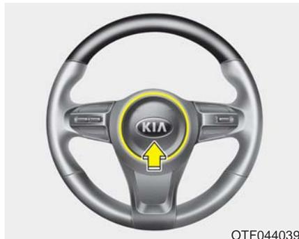
按下方向盘上的喇叭标志，喇叭响起。定期检查喇叭工作状态，确认喇叭正常工作。
