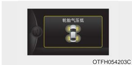
轮胎压力监测系统警告灯亮时，说明您车辆的一个或多个轮胎充气压力明显不足。低压轮胎位置指示灯亮，表示对应位置轮胎的充气压力明显过低。
