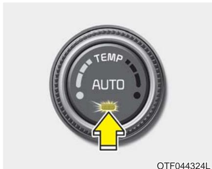
1. 按下自动(AUTO)按钮。通过温度设定自动控制通风模式、鼓风机速度、内外气选择及制冷系统的运转。
