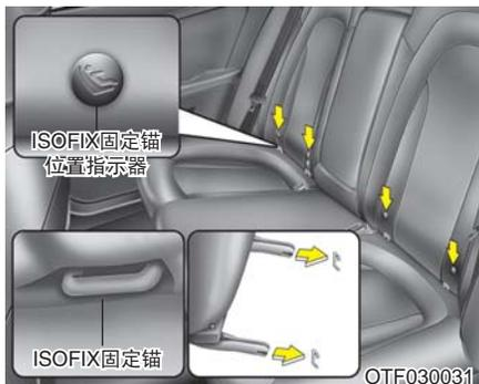
在每侧的后座椅靠背下方都标记有儿童保护座椅符号。这些符号指示配备儿童保护座椅下固定锚栓的位置。
