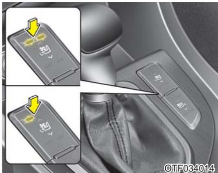
座椅加热器在寒冷季节加热前座椅。在发动机起动/停止按钮位于"ON"位置的情况下，按下开关即可加热座椅。
