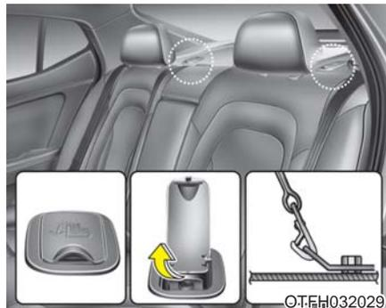
连接儿童保护座椅固定带挂钩的固定锚栓位于后座椅靠背顶部后方窗台上。
