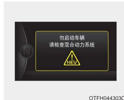
如果发动机不能启动并充电状态(SOC)非常低或车辆混合动力系统有故障，LCD显示器上显示“勿启动车辆，请检查混合动力系统”警告信息，并警告音响起，直到排除故障为止。
