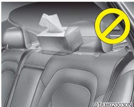
混合动力蓄电池冷却进气口位于后座椅后部，通过进气口进入空气冷却混合动力蓄电池。如果混合动力蓄电池进气口被堵塞，可能会导致混合动力蓄电池过热。禁止异物盖住进气口。
