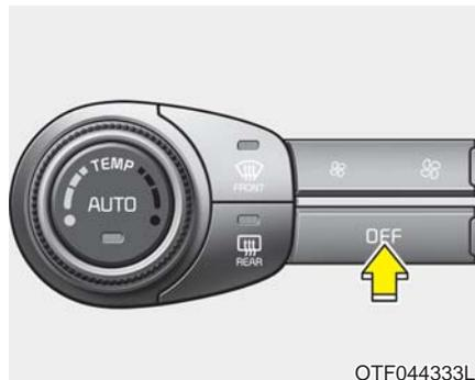
按下OFF按钮即可关闭空调控制系统。只要发动机启动/停止按钮位于"ON"位置，就能操作内外气选择按钮。
