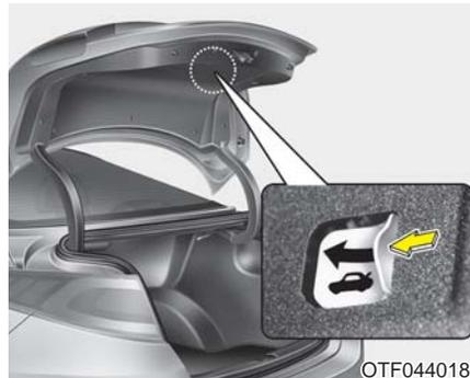
您的车辆在行李箱内配备了紧急行李箱盖释放杆。如果有人被意外锁进行李箱内，可朝箭头方向移动手柄，释放行李箱盖碰锁机构并打开行李箱盖。
