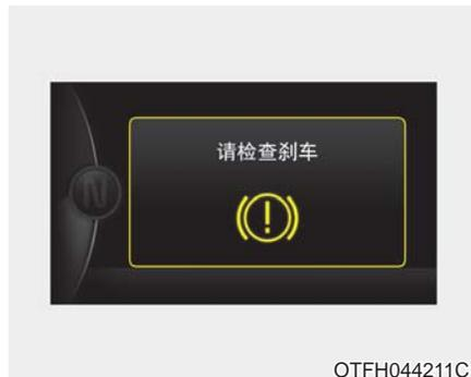
当制动功能不良或因制动系统故障再生制动系统不工作时，显示“请检查刹车”警告信息。
