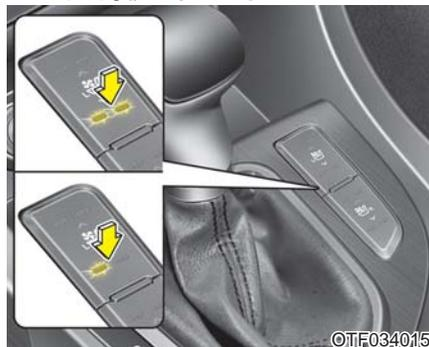
提供了通风座椅，在炎热天气里通过座椅和座椅靠背表面上的小通风口鼓风来冷却驾驶席座椅。发动机运转期间，按下开关冷却座椅。
