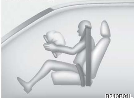
正面空气囊总成位于方向盘中央和助手席前手套箱上方的仪表板内。当SRSCM检测到车辆正面碰撞严重性达到一定程度时，自动展开正面空气囊。
