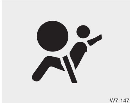
仪表盘上的空气囊警告灯用于警告驾驶员空气囊-辅助保护系统(SRS)可能有故障。
