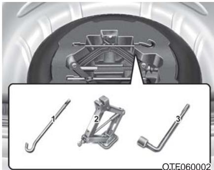
千斤顶、千斤顶手柄和车轮螺母扳手储存在行李箱内。提起行李箱底盖，可拿到这些工具。
