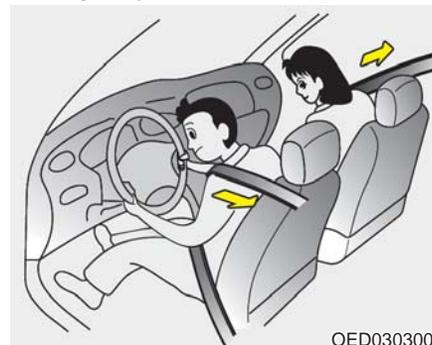
您车辆配备了驾驶席和助手席安全带拉紧器。配备此拉紧器的目的是为了在发生一定程度的正面碰撞事故时确保安全带紧固乘员的身体。当发生正面碰撞事故，其严重性达到一定程度时安全带拉紧器可能启动。
