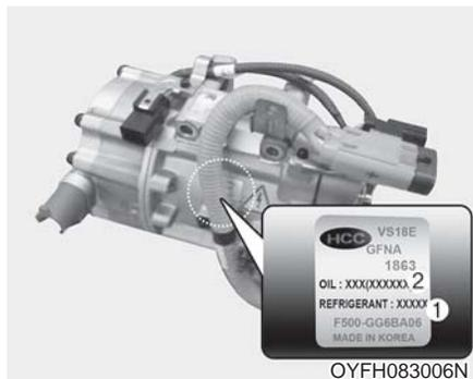
压缩机标签通知您车辆配备的压缩机类型如型号、供应商部件号、生产编号、制冷剂(1)和制冷剂油(2)。
