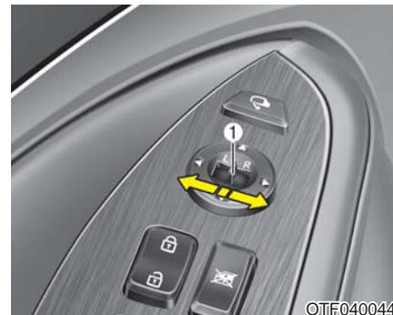
用电动远程控制后视镜开关可以调整左右室外后视镜的位置。要调整任意后视镜的位置，发动机启动/停止按钮应在ACC位置。
