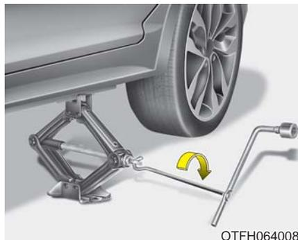
8. 把千斤顶手柄插入千斤顶并顺时针旋转，举升车辆直到轮胎刚好离地。离地间隙约30mm。在拧下车轮螺母前，确认车辆静止，并且没有滑动或移动的危险。
