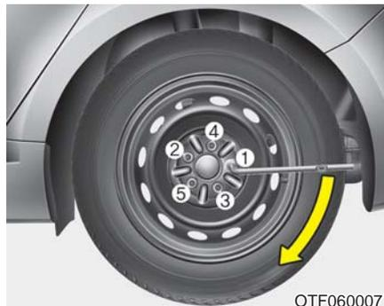
然后按图示放置扳手并拧紧车轮螺母。确定套筒完全套在螺母上。禁止站在扳手手柄上或在扳手手柄上使用延长管。顺着车轮紧固每个螺母，直到它们全部被拧紧为止。再次检查每个螺母的紧固情况。更换车轮后，请Kia授权经销商检查系统。
