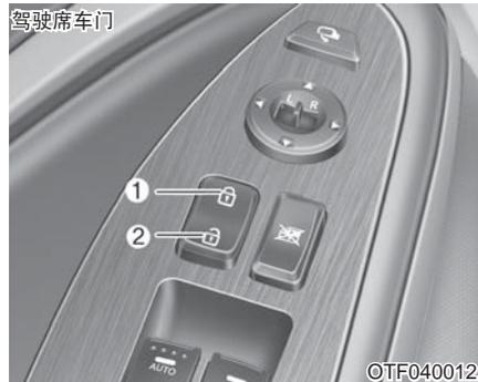
通过按动中央控制门锁操纵开关可操作中央控制门锁。
