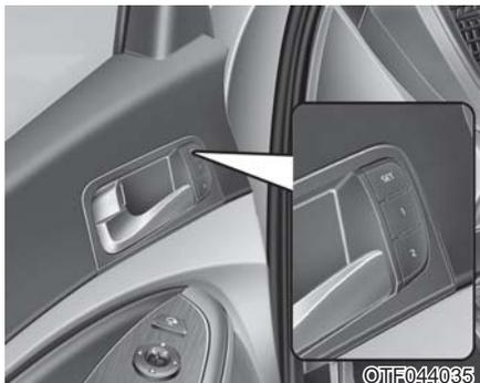
在车辆上提供了驾驶席位置记忆系统，借助简单的按钮操作存储和恢复驾驶席座椅的位置。可以存储并恢复2名驾驶员的不同的驾驶席座椅位置。如果拆装了蓄电池或蓄电池亏电，会删除位置记忆信息，此时应重新存储驾驶席座椅位置。
