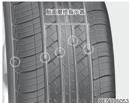
如果轮胎磨损均匀，胎面磨损指示器将作为横过胎面的硬带出现。这表示胎面剩余厚度不足1.6mm。此时应更换轮胎。
