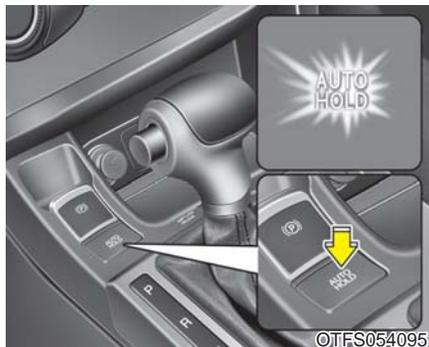
1. 在驾驶席车门、发动机罩和行李箱盖关闭状态下，佩戴好驾驶席安全带或踩下制动踏板，按下自动固定按钮。白色AUTO HOLD指示灯亮，系统进入预备状态。
