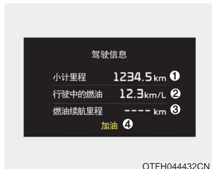
显示器显示行程距离(1)、平均油耗(2)和使用剩余燃油可驾驶车辆行驶的剩余距离(3)。
