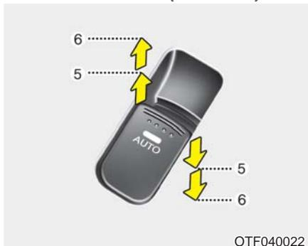
短暂按下或拉起电动门窗开关至第二止动位置(6)，即使释放开关，也会完全打开或关闭门窗。操作门窗的过程中要使门窗停在理想位置，可朝与门窗运动相反的方向拉起或按下并释放开关。
