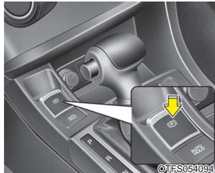
要释放EPB(电子驻车制动器), 在下列条件下按下EPB开关:
