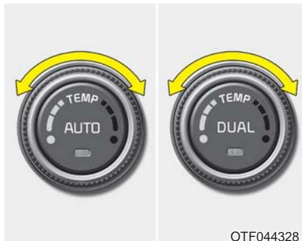
把温度控制旋钮向右转动直到极右位置，可提高温度直到最高(HI)温度。把温度控制旋钮向左转动直到极左位置，可降低温度直到最低(LO)温度。转动温度控制旋钮时，温度以0.5°C为单位升高或降低。设定到最低温度设置时，空调会持续运转。
