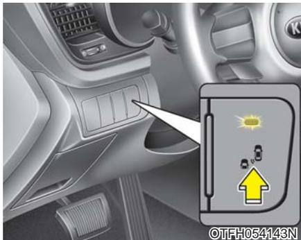
在发动机起动/停止按钮ON状态下，按下后侧方盲区警告(BSD)系统开关时，开关上的指示灯亮。
