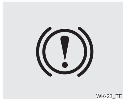
把发动机起动/停止按钮置于ON位置(不起动发动机)，检查驻车制动警告灯。在发动机起动/停止按钮置于START或ON位置状态下设置驻车制动器时，此警告灯亮。
