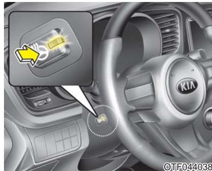
发动机启动/停止按钮在ON位置时，按下加热方向盘按钮可以加热方向盘，按钮上的指示灯亮。
