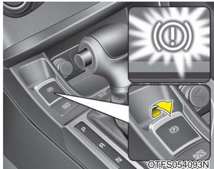
要应用EPB(电子驻车制动器), 执行下列操作:
