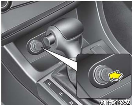
发动机启动/停止按钮必须位于"ACC"位置或"ON"位置，才可使用点烟器。
