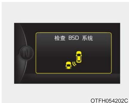
如果系统不正常工作，会出现一条警告信息并且开关上的灯熄灭。系统自动关闭。
