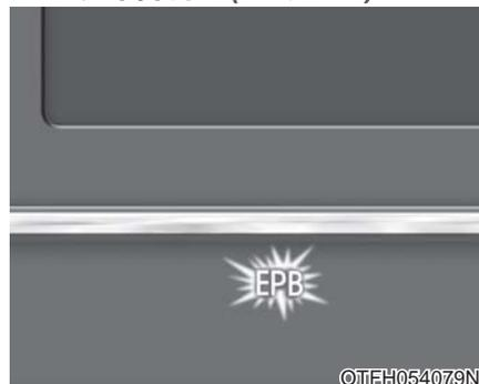
此警告灯在发动机起动/停止按钮转至ON位置时亮，如果系统正常工作，警告灯在约3秒内熄灭。
