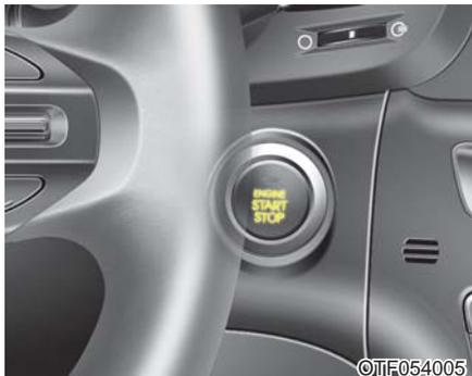
无论何时打开前车门，发动机起动/停止按钮照明灯亮，为您提供便利。照明灯在关上车门约过30秒钟后熄灭。也在防盗警报系统进入警戒状态时立即熄灭。
