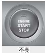
要停止发动机(起动/运转位置)或关闭车辆电源(ON位置)，在变速杆位于"P(驻车)"位置时按下发动机起动/停止按钮。如果在变速杆不在"P(驻车)"位置的情况下按下发动机起动/停止按钮，发动机起动/停止按钮不转至OFF位置，而是转至ACC位置。
