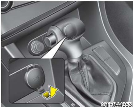
电源插座用于给手机或其它与车上的电气系统一起工作的装备提供电源。混合动力系统运转时此插座可提供10A，12V以下的电能。
