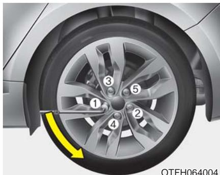
6. 逆时针方向转动每个车轮螺母1圈来松动轮胎螺母，但在轮胎离地之前不要拧下螺母。
