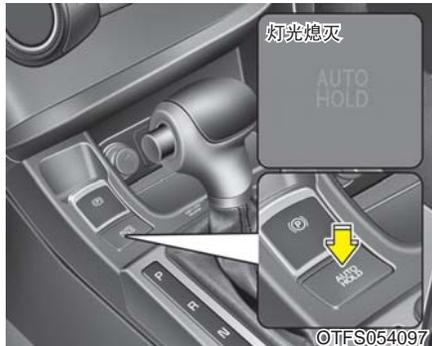
要撤销自动固定操作，请按下自动固定开关。自动固定指示灯熄灭。要在车辆静止时撤销自动固定操作，在踩下制动踏板状态按下自动固定开关。
