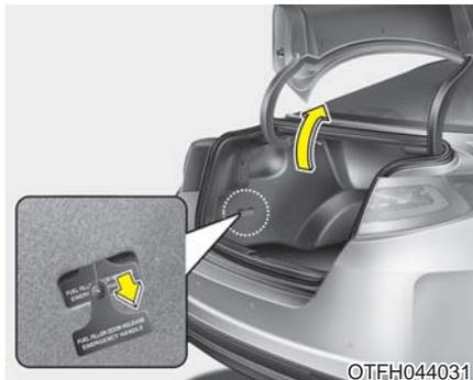
如果使用遥控燃油加油口门释放装置没有打开燃油加油口门，可通过轻微朝外拉把手来手动打开燃油加油口门。
