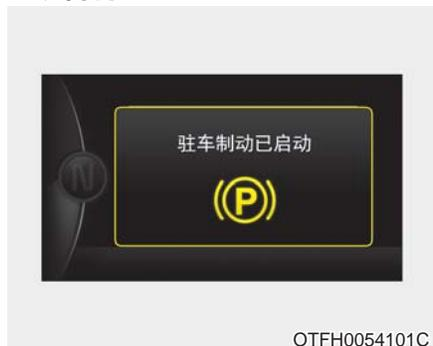
在自动固定功能工作期间，如果因ESC(电子稳定控制)信号使EPB应用，警告音响并显示警告信息。
