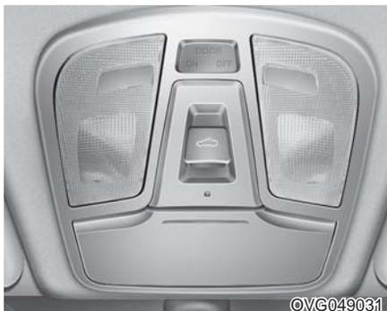
如果您的车辆配备天窗，您可以使用头顶控制台上的天窗控制杆滑动操作或倾斜操作天窗。
