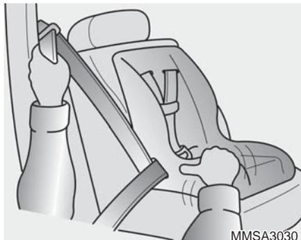
3. 扣上安全带扣环并收回安全带松弛部分。安装儿童保护座椅后，试探性地朝各个方向移动儿童保护座椅，确定儿童保护座椅安装牢固。
