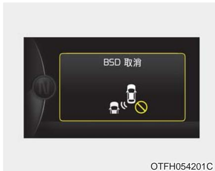
显示此信息，通知驾驶员后保险杠上有杂质或后保险杠附近很热。开关上的灯自动熄灭，系统自动关闭。除去后保险杠上的杂质。
