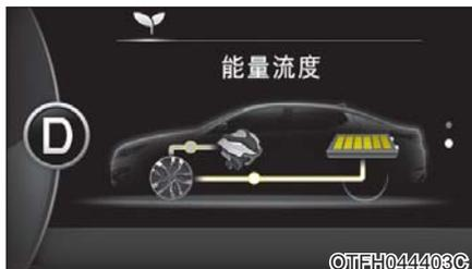
能使用发动机制动放慢车辆。能使用再生制动系统给混合动力系统充电。
