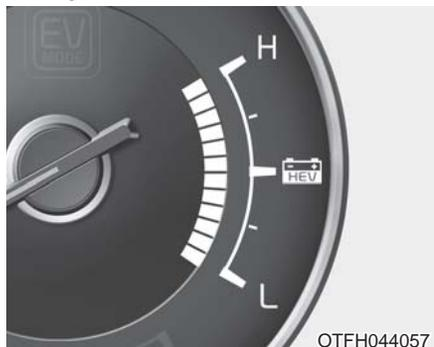
充电状态(SOC)表指示混合动力蓄电池的充电程度。
