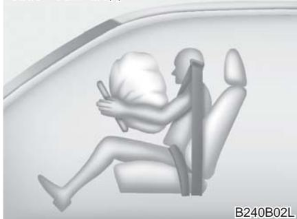
空气囊展开时，直接模压在装饰盖内的撕裂接缝会在空气囊的膨胀压力作用下被分离。装饰盖进一步打开，空气囊完全展开。
