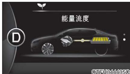
车辆处于停止状态，发动机给混合动力蓄电池充电。
