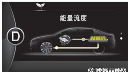
使用发动机制动和再生制动放慢车辆。使用再生制动给混合动力蓄电池充电。
