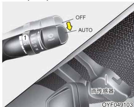
雨传感器位于挡风玻璃上端，检测降雨量并以适当间隔时间控制刮水周期。降雨量越多，雨刮器运转间歇时间越短。不再下雨时，雨刮器停止运转。
