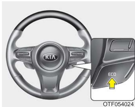
主动ECO通过控制某些发动机和变速器系统操作参数帮助提高燃油效率，燃油效率取决于驾驶员的驾驶习惯和路况。
