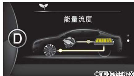
发动机和再生制动系统给混合动力蓄电池充电，减速行驶。
