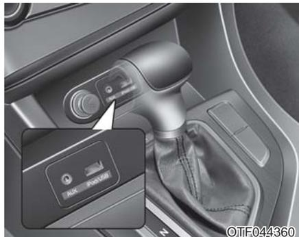
如果您的车辆配备Aux和/或USB(通用串行总线)插口或iPod®插口, 可使用Aux插口连接外部音响播放设备, 使用USB插口连接USB设备, 使用iPod®插口连接iPod®设备。
