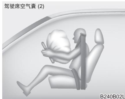
驾驶席空气囊展开时，直接模压在防撞盖内的撕裂接缝会在空气囊的膨胀压力作用下被分离。进一步打开防撞盖，空气囊完全展开。
