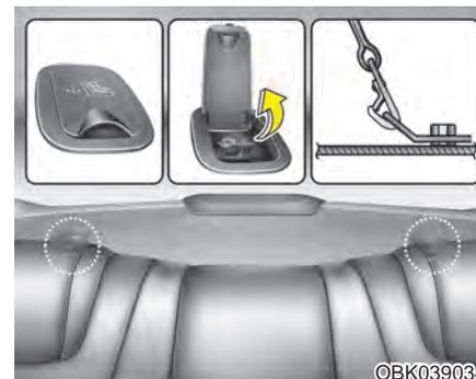
**使用“固定锚装置”系统紧固儿童保护座椅**
