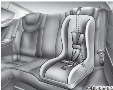
1. 将儿童保护座椅搭接片置于座椅靠背上方。
