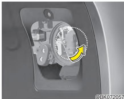
6. 逆时针转动灯泡插座直到灯泡插座上的舌片对正总成上的导槽，即可从总成上拆下灯泡插座。
