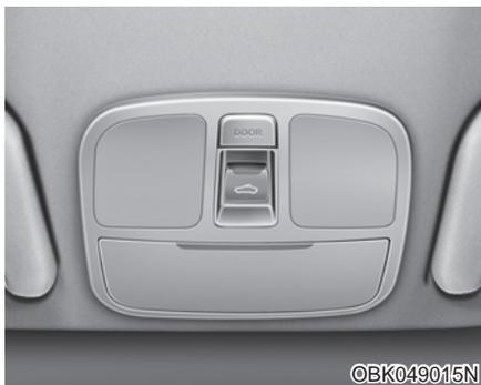
如果您的车辆配备天窗，您可以使用头顶控制台上的天窗控制开关滑动或倾斜天窗。
