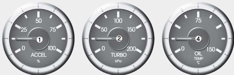
组合仪表包括加速踏板位置表、涡轮增压压力表(2.0L发动机)、发动机扭矩表(3.8L发动机)、发动机机油温度表。
