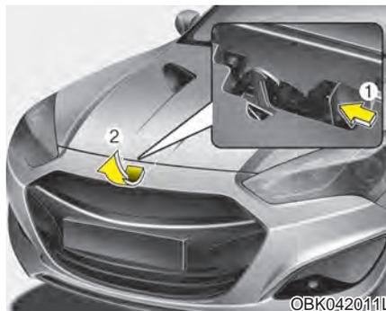
2. 来到车辆前方，缓慢举升发动机罩，上推发动机罩中央内侧的第二挂钩(1)并举起发动机罩(2)。
