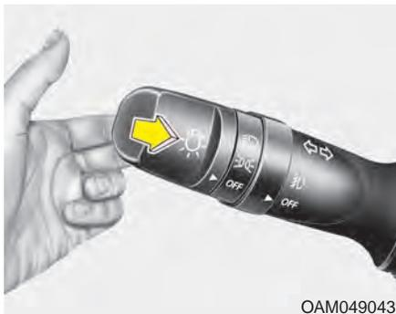
要使大灯闪光，可以朝您所在的方向拉控制杆。松开控制杆后可返回正常位置(近光)，使用闪光功能时不需要接通大灯开关。
