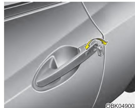
2. 向车后旋转钥匙可开锁车门, 向车前旋转钥匙可闭锁车门。
