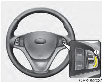
3. 向下移动杆(1)(SET-), 在理想的速度释放它。仪表盘内的SET指示灯将亮。释放加速踏板，将自动维持理想的速度。
