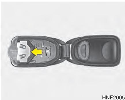
2. 更换新品电池(CR2032)。更换电池时，确保电池正极“+”符号朝上。
