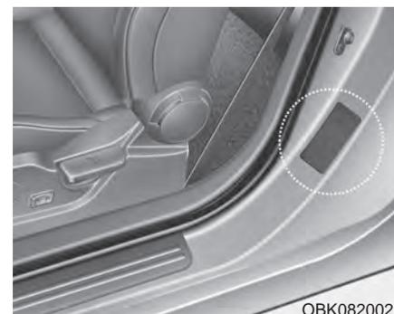
附着在驾驶席(或助手席)侧中央立柱上的车辆识别标签上标明了车架号(VIN)。
