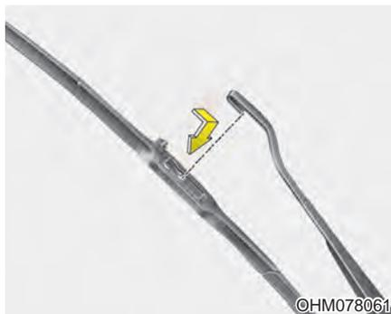
3. 按拆卸的反顺序安装新雨刮器刮片总成。
